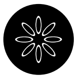
品号:190185000007 外径:Ø18.5 图案:Ø13 厚度:1.5mm 位置:4
